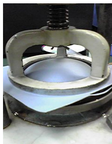
防水試験(JIS K 6404 ) 0.3MPa(水圧)×1分間で漏れ無し
