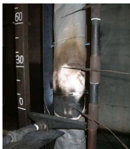
垂直トレイ燃焼試験(JIS C 3521) 800℃×20分間燃焼後、通気遮断層の 破れ無し
